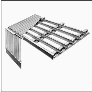
Typische Zweifeldprofil-Anordnung mit Pfetten- und Stoßlaschenpositionen
